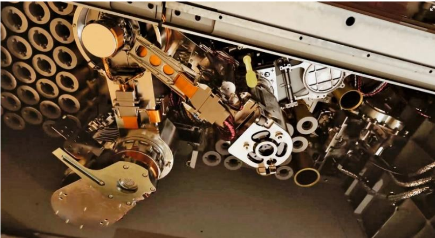
Le bras du robot déplace les échantillons de sol pour un examen visuel et volumique, puis vers la station de scellage, et pour finir à leur emplacement de stockage provisoire – et ce, en toute autonomie. Photo: NASA/JPL-Caltech
