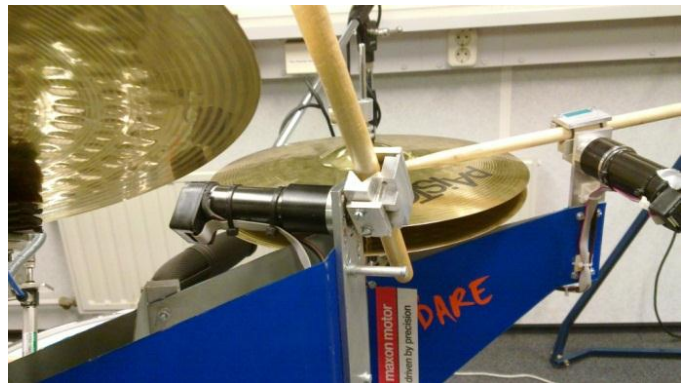
Abbildung 4: Der „Crash“ und der „hi-hat“ des Schlagzeugs sind je mit einem maxon-Antrieb ausgestattet. © 2011 TeamDARE
